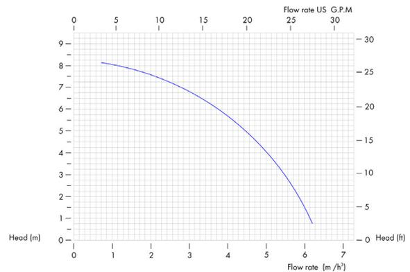
Las curvas y valores de rendimiento se refieren a bombas con salida de suministro libre con agua a 20 °C y motor bipolar 50 Hz. Estos datos pueden variar según los materiales de construcción y las condiciones hidráulicas.
