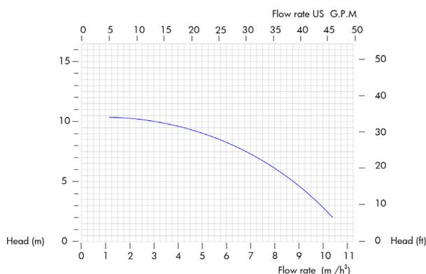
Las curvas y valores de rendimiento se refieren a bombas con salida de suministro libre con agua a 20 °C y motor bipolar 50 Hz. Estos datos pueden variar según los materiales de construcción y las condiciones hidráulicas.
