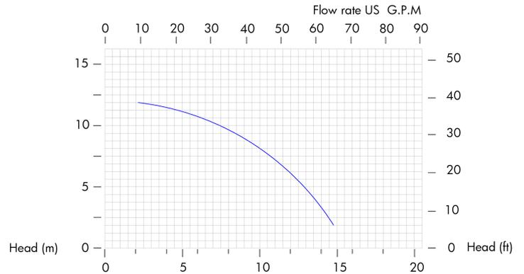
Las curvas y valores de rendimiento se refieren a bombas con salida de suministro libre con agua a 20 °C y motor bipolar 50 Hz. Estos datos pueden variar según los materiales de construcción y las condiciones hidráulicas.
