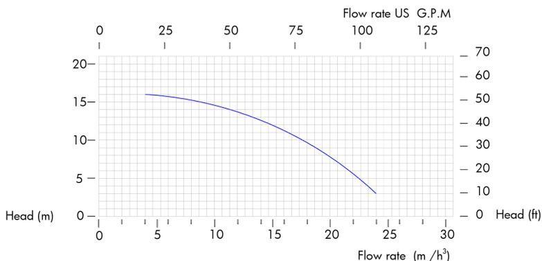
Las curvas y valores de rendimiento se refieren a bombas con salida de suministro libre con agua a 20 °C y motor bipolar 50 Hz. Estos datos pueden variar según los materiales de construcción y las condiciones hidráulicas.
