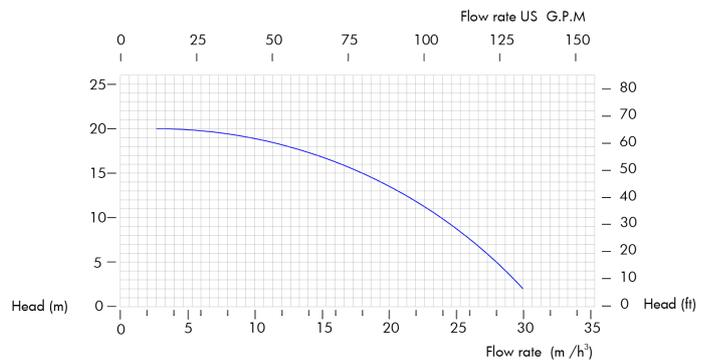
Las curvas y valores de rendimiento se refieren a bombas con salida de suministro libre con agua a 20 °C y motor bipolar 50 Hz. Estos datos pueden variar según los materiales de construcción y las condiciones hidráulicas.
