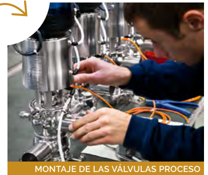
MONTAJE DE LAS VÁLVULAS PROCESO
